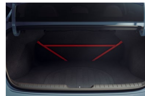
Barre antirapprochement arrière renforçant la rigidité de la carrosserie de 29 % par rapport au modèle ELANTRA standard
